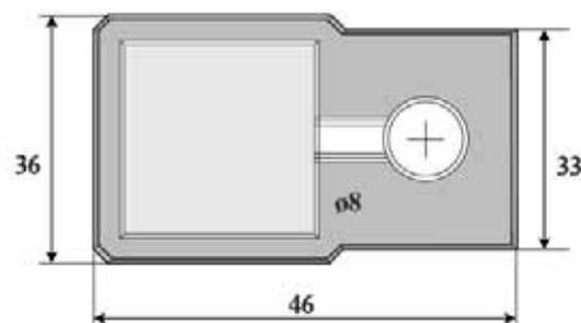
Plinto prefabbricato in calcestruzzo per l'installazione di piccoli pali per illuminazione dotato di pozzetto ispezionabile e predisposizione foratura laterale per le connessioni di ingresso ed uscita.
