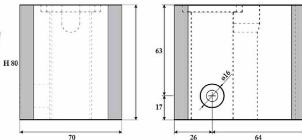
Plinto prefabbricato in calcestruzzo per l'installazione di pali per illuminazione dotato di pozzetto ispezionabile e fori laterali per le connessioni di ingresso ed uscita.
