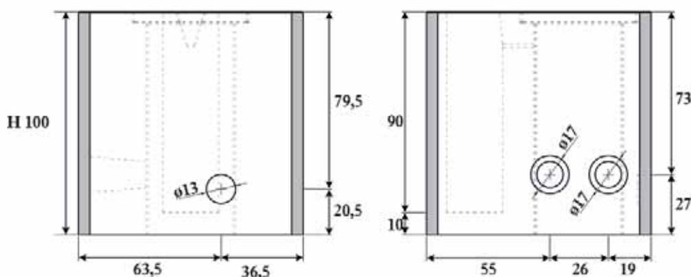
Plinto prefabbricato in calcestruzzo per l'installazione di pali per illuminazione dotato di pozzetto ispezionabile e fori laterali per le connessioni di ingresso ed uscita.
