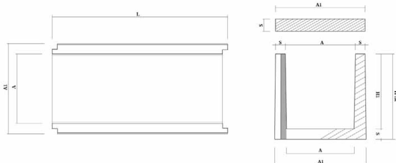
Utilizzate sia per la raccolta delle acque superficiali, sia come canale tecnico per l'alloggiamento di reti di distribuzione di servizi tecnologici. Su richiesta sono disponibili anche le coperture.
