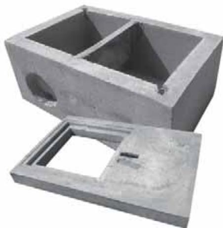
Caditoia stradale a doppia tenuta idraulica e meccanica, costituita da un manufatto in conglomerato cementizio per la raccolta, la sedimentazione ed il convogliamento delle acque piovane verso la fognatura. Grazie agli scomparti sifonati evita il passaggio molesto di cattivi odori provenienti dalla fognatura. Prolungabile con apposito manufatto cm 50x50 spess. 8xh50 e h25 (chiusino caditoia non compreso nella fornitura).
