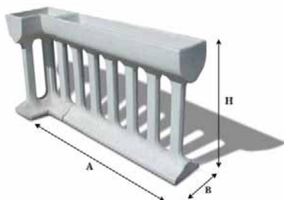
Le nostre **fioriere-parapetto** sono realizzate con l'impiego di calcestruzzo di cemento bianco e materie prime scelte ed armate con acciaio e fibre di polipropilene per evitarne gli inestetismi. Sono costituite da un pezzo monolitico composto da base piana, colonnine con sovrastante fioriera per la piantumazione di fiori ed essenze varie. E' disponibile anche nella versione ad angolo.
