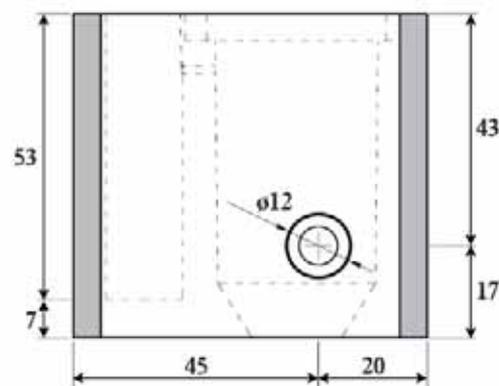
Plinto prefabbricato in calcestruzzo per l'installazione di pali per illuminazione dotato di pozzetto ispezionabile e fori laterali per le connessioni di ingresso ed uscita.
